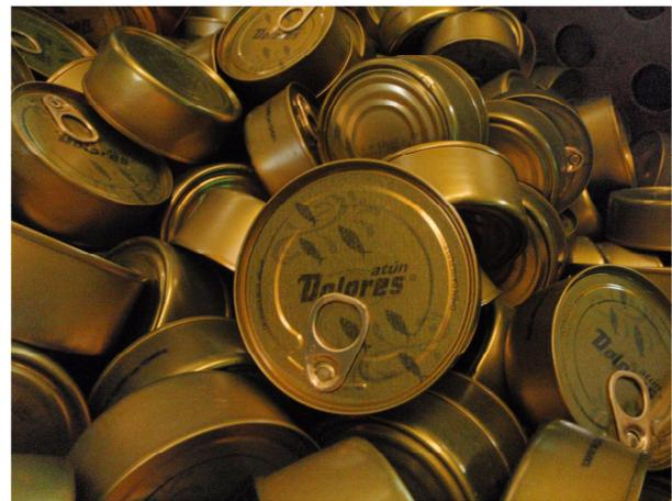
A las latas se les inyecta vapor saturado e higiénico en el espacio libre del envase y, en combinación con una temperatura alta de los líquidos, se elimina el aire del envase. Inmediatamente después se coloca la tapa, con esto cerrándola herméticamente y al vacío.
